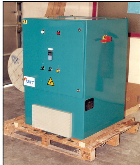
Thermorégulateur Huile de 48 KW pour déshydratation de pralines pour chocolaterie / Thermal oil thermoregulator 48 KW for pralines dehydration in chocolate factory
