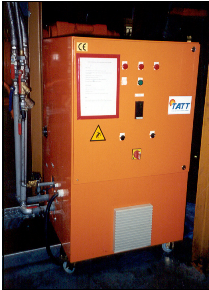
Thermorégulateur Eau surchauffée 12 Kw pour régulation de température sur calandreuses de plaques / Superheated water thermoregulator 12 KW for temperature control on plate rolling machine
